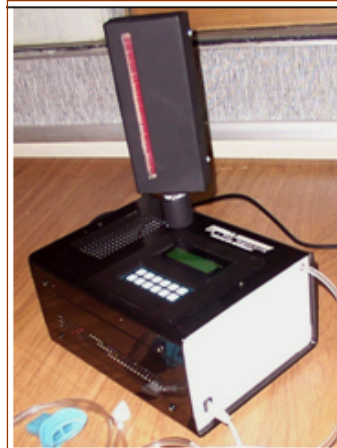
- Figura 1 - Vista del prototipo de PREMAX. Notar la columna luminosa proporcional al esfuerzo del paciente, el display y la pieza de boca abajo a la izquierda.
